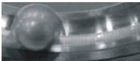
Rayado (fluting) causado por la corriente eléctrica en el cojinete.
