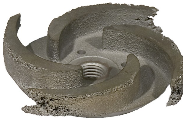
Efectos de la cavitación de impulsión
