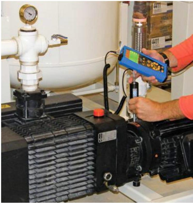
*Capturando mediciones de ultrasonido dinámico en un motor controlador eléctrico.*
