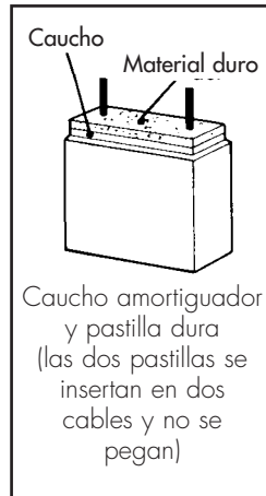
Dispositivo de limitación de desgaste mediante topes plásticos
