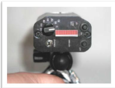
*Se debe lubricar hasta que el nivel de dB baje a su línea base.*
