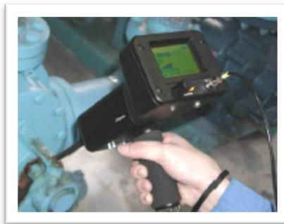
Las líneas base se establecen normalmente con un instrumento de ultrasonido portable
