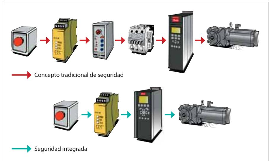
segura" para este propósito – la función de parada satisface la categoría 3 de parada según EN 60204-1. Con esta solución pueden evitarse los componentes externos caros y voluminosos, simplificar el cableado y minimizar los tiempos de parada. Y las señales de seguridad pueden transferirse mediante señales discretas cableadas (en una instalación compacta), o mediante un bus seguro de comunicaciones (en plantas extensas de fabricación). El acoplamiento del relé de seguridad
