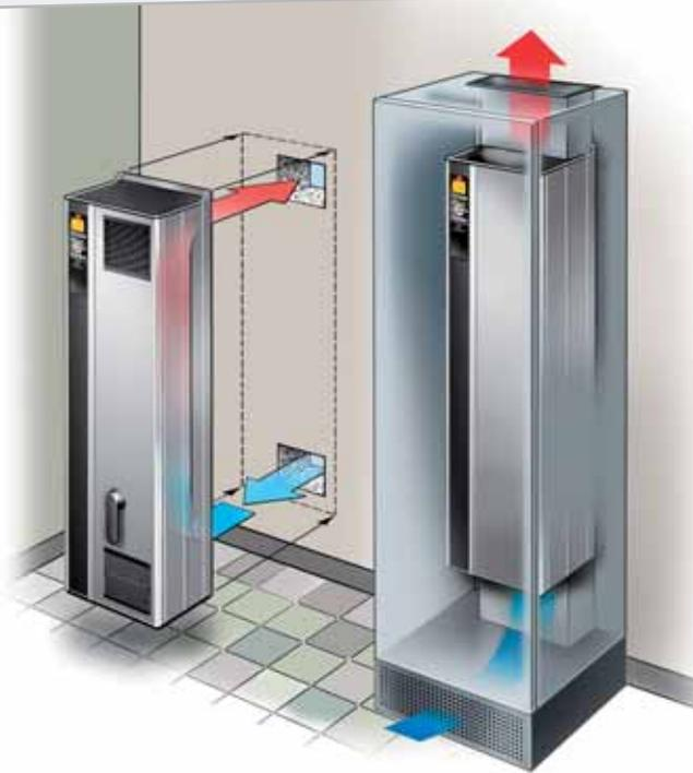
*El innovador diseño reduce el riesgo de que entren contaminantes en el convertidor y en el panel, y asegura una larga vida útil de los convertidores. Con el kit de conductos de refrigeración el exceso de calor puede enviarse fuera de la sala de control – y fuera del edificio. La necesidad de componentes adicionales para acondicionamiento del aire y el consumo de energía de estos componentes es limitado.*
