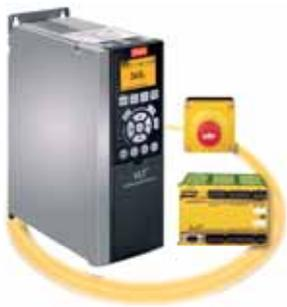
El VLT® AutomationDrive FC 302 viene estándar con la funcionalidad de Parada de Seguridad de categoría 3, según define la norma EN 954-1. Esta característica evita que un convertidor arranque accidentalmente. Esto es crucial para aplicaciones en las que la prevención de arranques sin supervisión sea de vital importancia. El terminal 37 del FC 302 puede utilizarse como "inercia
