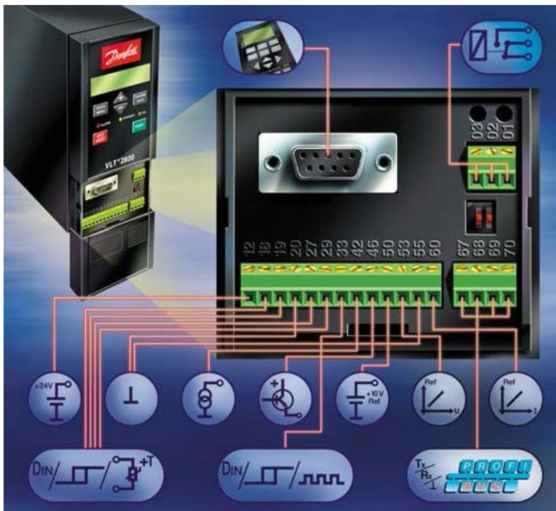
Fig.21: Conexiones VLT2800
