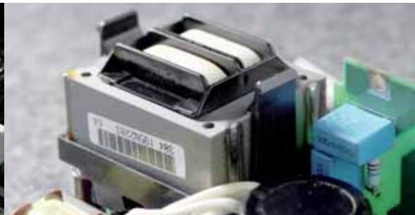
Bobina de CC integrada
