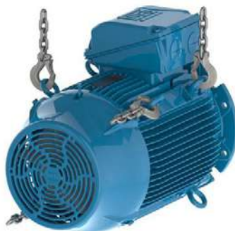
Figura 4.11 – Instalação do segundo par de olhais.
