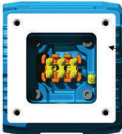
Figura 8.2 - Superfície usinada da caixa de ligação do motor à prova de explosão.
