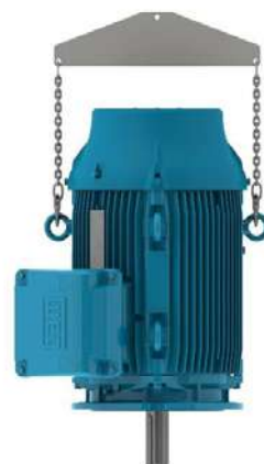
Figura 4.8 - Izamiento de motores verticales.
