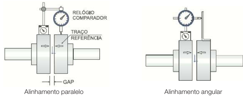
Figura 6.11 – Alinhamento com relógio comparador.
