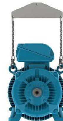
Figura 4.7 – Uso de barra separadora no içamento.
