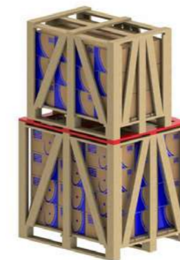
Figura 5.5 - Utilização de sarrafos adicionais para empilhamento.
