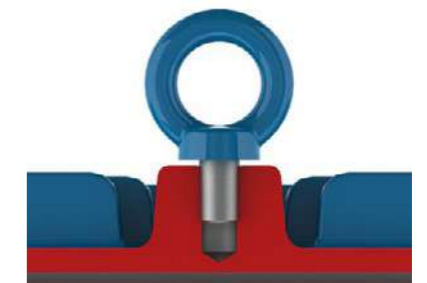
Figura 4.2 – Maneira incorreta de fixação do olhal de içamento
