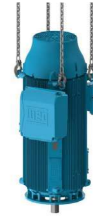
Figura 4.9 - Izamiento de motores HGF.
