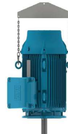
Figura 4.8 – Içamento de motores verticais.
