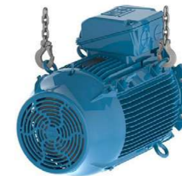
Figura 4.20 – Resultado final: motor posicionado na posição horizontal.
