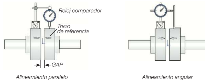
Figura 6.11 - Alineamiento con reloj comparador
