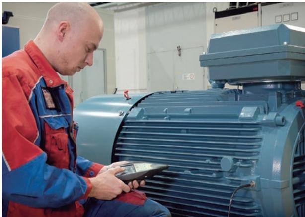
**Figura 5.8** Test de vibración
