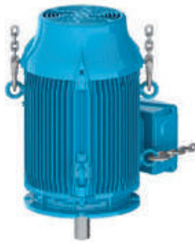
Рисунок 4.12 - Конечный результат: электродвигатель расположен вертикально
