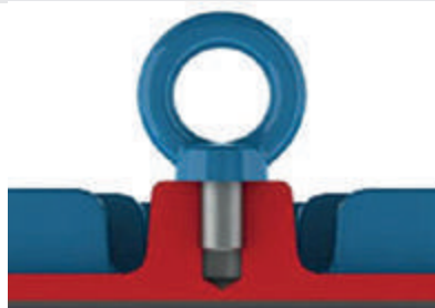
Фигура 4-1 – Правилно затягане на болта с халка
