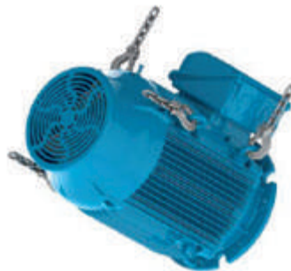
Рисунок 4.19 - Вращение двигателя в горизонтальное положение
