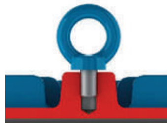
Рисунок 4.2 - Неправильное затягивание рым-болта
