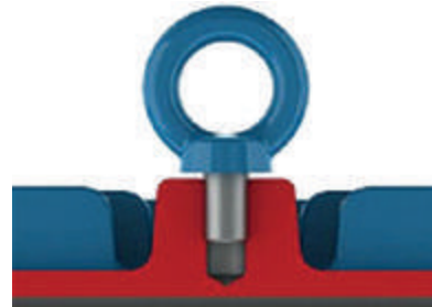
Figurii 4.2 - Strângerea incorectă a unui șurub cu ochi
