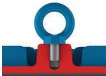
Рисунок 4.1 - Правильное затягивание рым-болта
