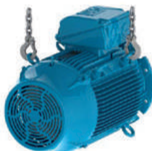
Рисунок 4.20 - Конечный результат: электродвигатель расположен горизонтально
