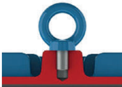
Figurii 4.1 - Strângerea corectă a unui șurub cu ochi
