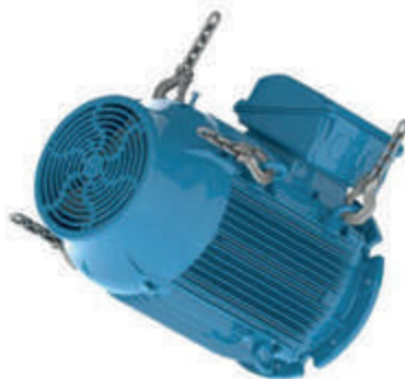
Фигура 4.19 - Двигателят се завърта в хоризонтално положение
