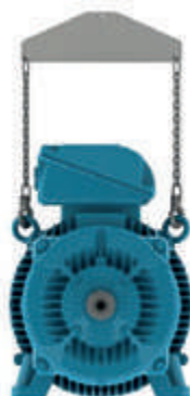
Фигура 4-7 – използване на раздалечителен елемент
