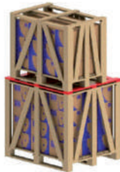
Bild 5.5 - Einsatz von zusätzlichen leisten zum stapeln von lattenkisten
