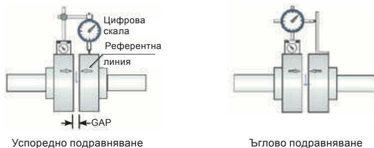
Фигура 6-11 – Подравняване с уреди с цифрова скала
