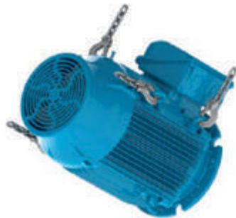
Bild 4.19 - Der Motor wird in die horizontale Lage gewendet
