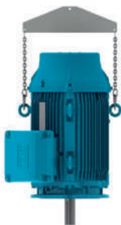
Figura 4.8 - Içamento de motores verticais
