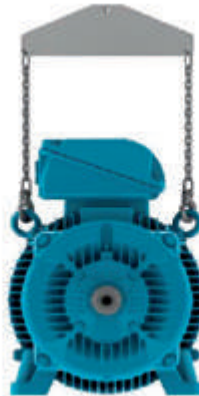
Bild 4.7 - Einsatz eines Querbalkens zum Heben
