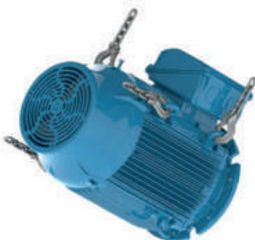
Figurii 4.19 - Motorul este rotit în poziția orizontală
