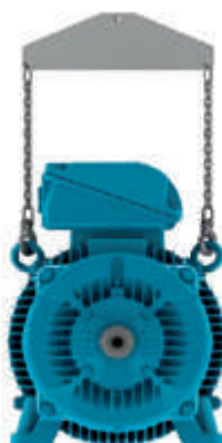
Figura 4.7 - Uso de barra separadora en la elevación
