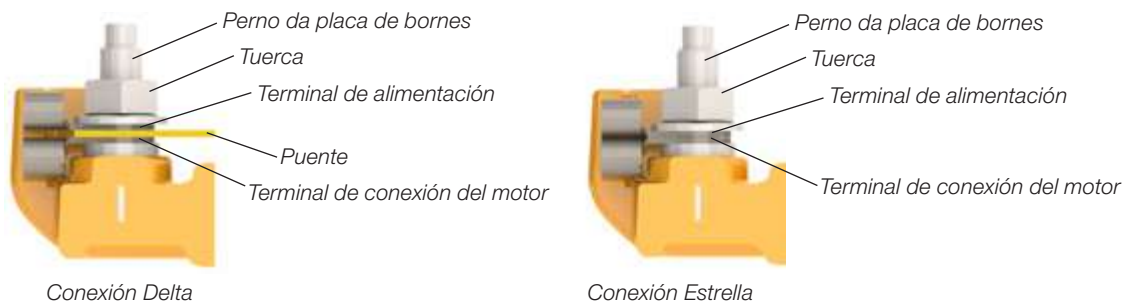
Figura 6.13 - Conexión para los motores W21 y W22 con placa de bornes
