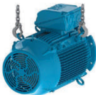
Рисунок 4.20 - Конечный результат: электродвигатель расположен горизонтально
