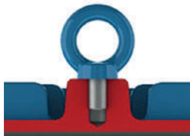
Figurii 4.1 - Strângerea corectă a unui șurub cu ochi
