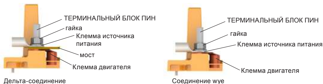
Рисунок 6.14 - Подключение для двигателей HGF, W40, W50 и W60 с клеммной колодкой
