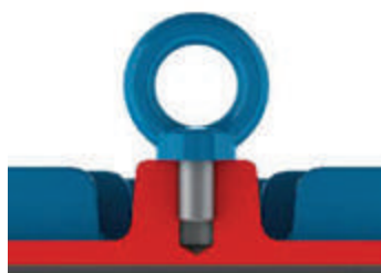
Рисунок 4.1 - Правильное затягивание рым-болта
