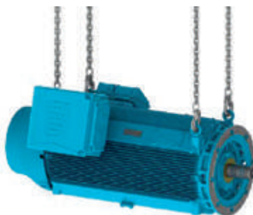
Рисунок 4.13 - Подъем электродвигателей серий HGF и W50 с использованием двух подъемных строп.
