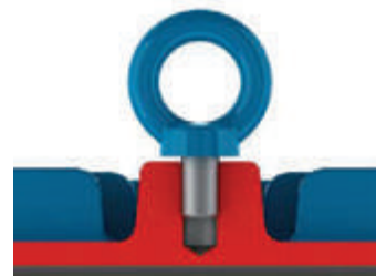
Рисунок 4.2 - Неправильное затягивание рым-болта
