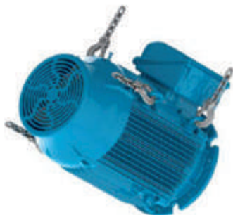
Figura 4.19 - Motor está sendo girado para a posição horizontal
