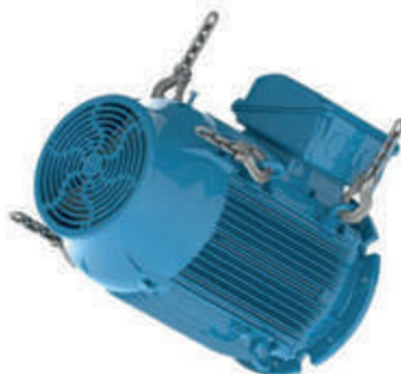
Фигура 4.19 - Двигателят се завърта в хоризонтално положение
