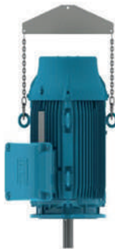
Figurii 4.8 - Ridicarea motoarelor montate pe verticală
