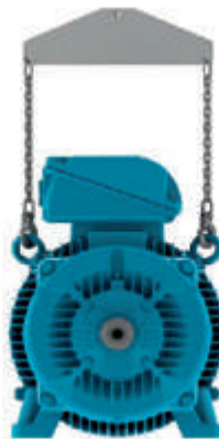
Figura 4.7 - Uso de barra separadora en la elevación
