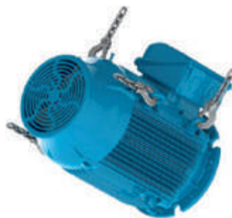
Figura 4.19 - Motor está siendo rotado para hacia la posición horizontal
