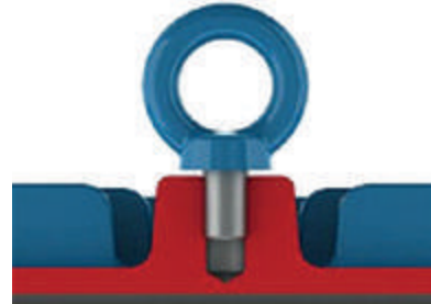
Figurii 4.2 - Strângerea incorectă a unui șurub cu ochi
