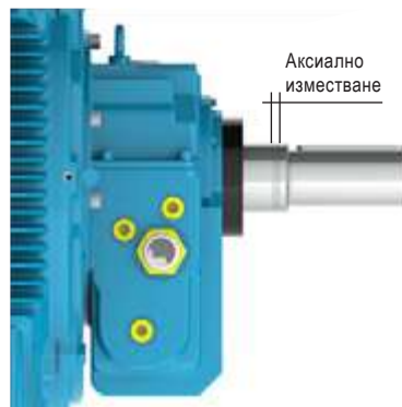
Фигура 6-10 – Аксиално изместване на двигател с плъзгащ лагер
