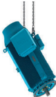
Figurii 4.15 - Ridicarea motoarelor HGF și W50 de la șuruburile de la capătul antrenat
