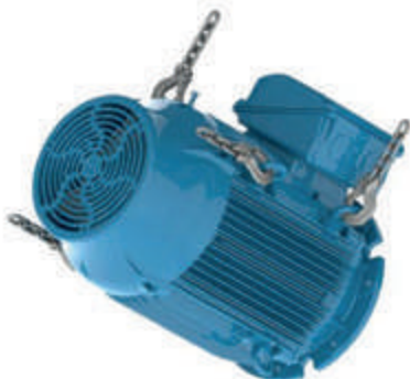
Figurii 4.19 - Motorul este rotit în poziția orizontală
