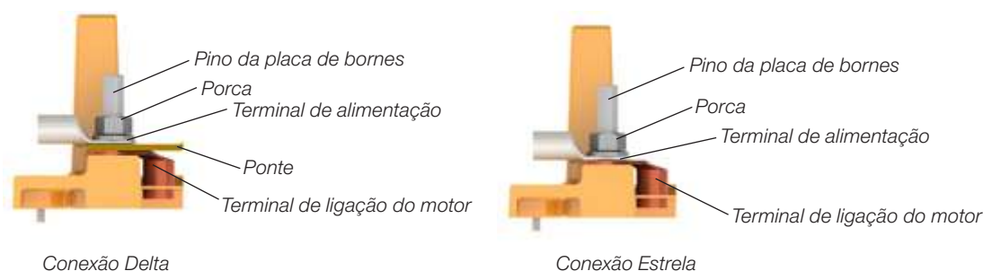
Figura 6.14 - Conexão dos cabos para motores HGF, W40, W50 e W60 com placa de bornes
