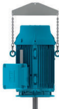
Figura 4.8 - Elevación de motores verticales
