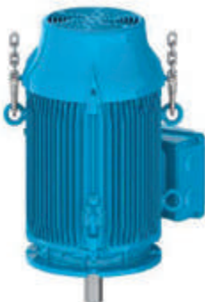
Figura 4.17 - Instalação do primeiro par de olhais
