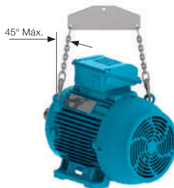
Bild 4.4 - Max. zugelassener Hebewinkel für Motoren mit zwei oder mehreren Transportösen
