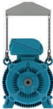
Figurii 4.7 - Utilizarea unei bare distanțier pentru ridicare
