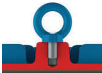
Рисунок 4.1 - Правильное затягивание рым-болта
