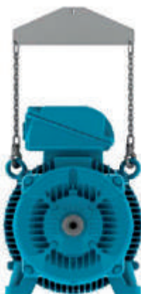
Figura 4.7 - Uso de barra separadora no içamento
