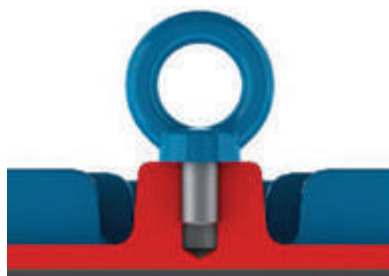
Bild 4.1 - Richtige Befestigung der Transportösen
