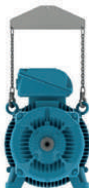
Фигура 4-7 – използване на раздалечителен елемент
