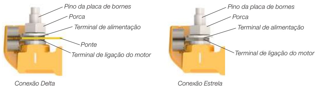
Figura 6.13 - Conexão dos cabos para motores W21 e W22 com placa de bornes
