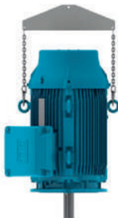
Рисунок 4.8 - Подъем электродвигателей вертикальной установки
