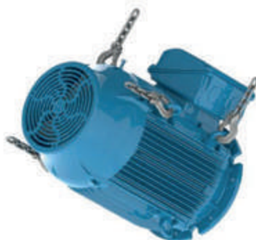
Фигура 4.19 - Двигателят се завърта в хоризонтално положение
