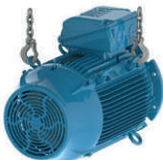
Фигура 4.20 - Краен резултат: двигател поставен в хоризонтално положение
