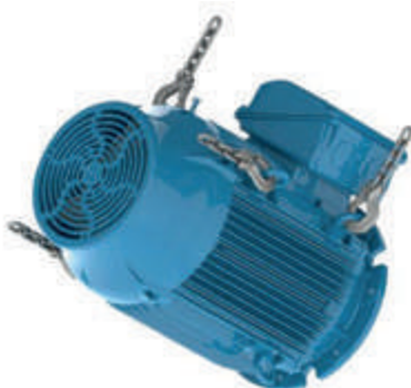
Figurii 4.19 - Motorul este rotit în poziția orizontală
