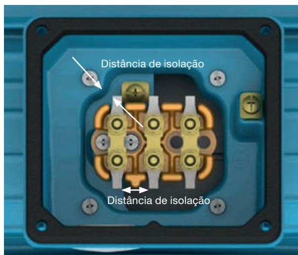
Figura 6.15 - Representação da distância de isolamento.
