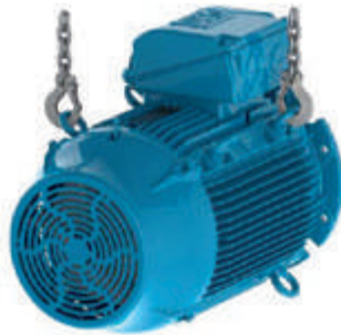
Bild 4.20 - Endergebnis: der Motor liegt in horizontaler Lage
