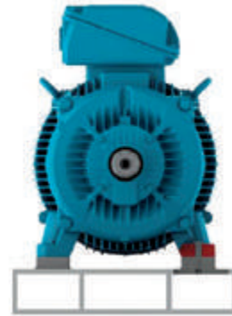
Bild 6.3 - Motor auf metallische Basis aufgestellt
