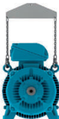
Рисунок 4.7 - Использование распорной траверсы при подъеме
