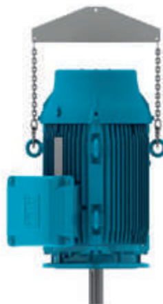
Bild 4.8 - Handhabung von vertikal aufgestellten Motoren
