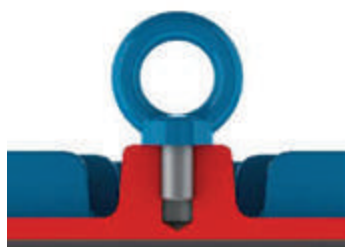
Рисунок 4.1 - Правильное затягивание рым-болта
