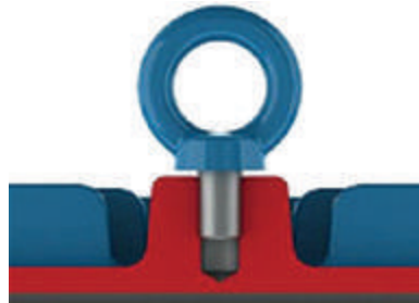
Figurii 4.2 - Strângerea incorectă a unui șurub cu ochi
