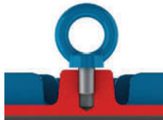
Рисунок 4.2 - Неправильное затягивание рым-болта
