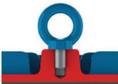
Bild 4.1 - Richtige Befestigung der Transportösen
