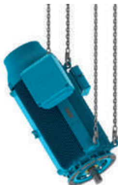
Figurii 4.14 - Aducerea motorului HGF și W50 în poziție verticală
