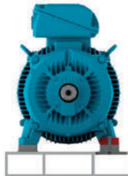
Figura 6.3 - Motor instalado sobre base metálica
