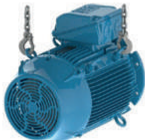
Figurii 4.10 - Scoaterea motorului din ambalaj
