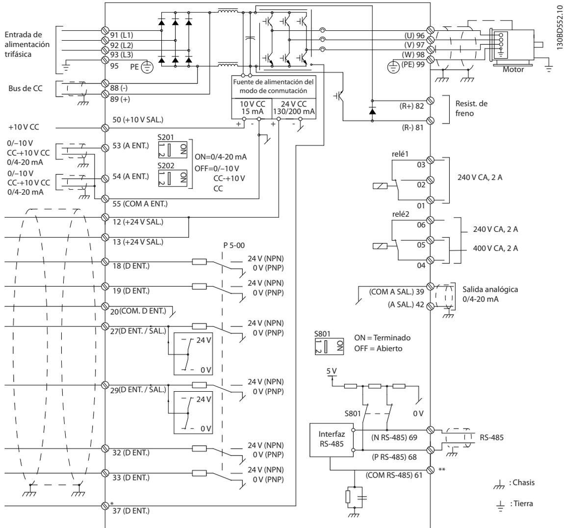
Ilustración 4.2 Esquema básico del cableado
