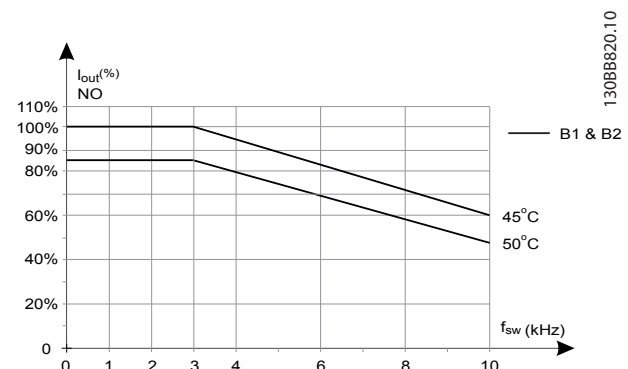
Ilustración 5.11 Reducción de potencia de la intensidad de salida con frecuencia de conmutación y temperatura ambiente para convertidores de frecuencia de 600 V, tamaño de protección B, 60 AVM, NO
