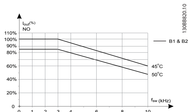
Ilustración 5.11 Reducción de potencia de la intensidad de salida con frecuencia de conmutación y temperatura ambiente para convertidores de frecuencia de 600 V, tamaño de protección B, 60 AVM, NO
