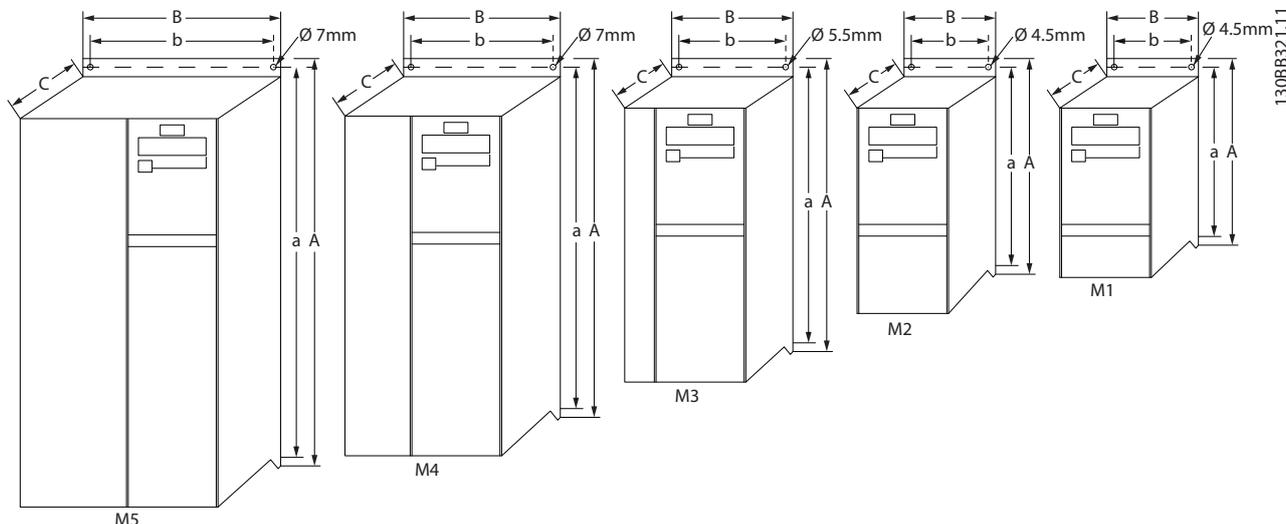
Ilustración 1.1 Dimensiones mecánicas
