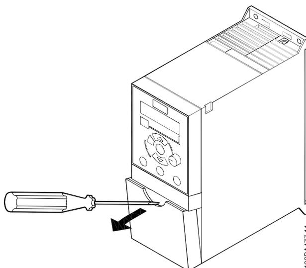
Ilustración 1.3 Desmontaje de la tapa de terminales
