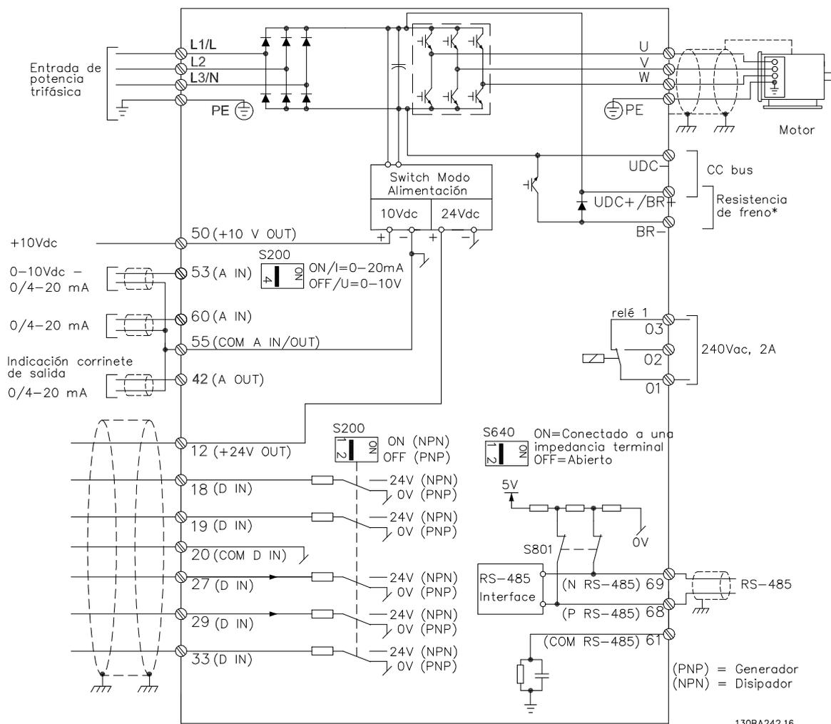
Ilustración 1.6 Diagrama que muestra todos los terminales eléctricos
