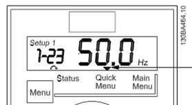
Ilustración 3.9 Indicación del modo Menú rápido
