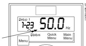
Ilustración 3.8 Indicación del modo Estado
