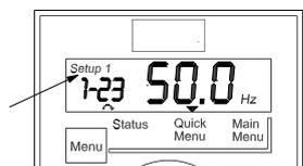
Ilustración 3.3 Indicación del ajuste
