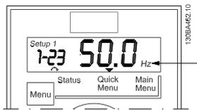
Ilustración 3.6 Indicación de la unidad del parámetro seleccionado
