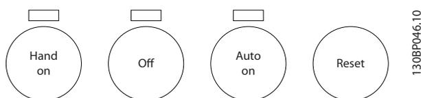
Ilustración 2.12 Teclas de control del GLCP
