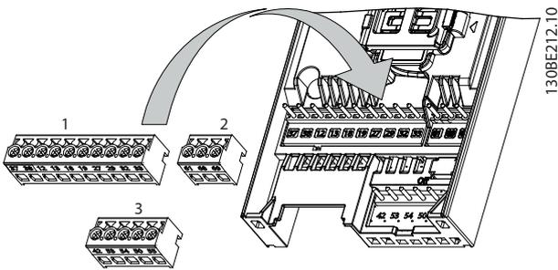
Ilustración 2.8 Ubicación de los terminales de control
