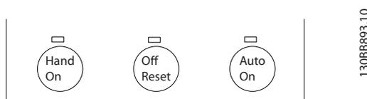
Ilustración 2.13 Teclas de control del NLCP
