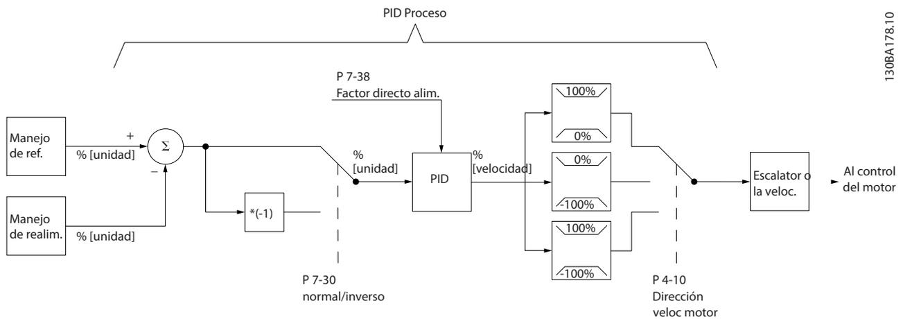
Ilustración 2.23 Diagrama del control de PID de procesos
