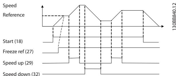
Ilustración 3.4 Aceleración/desaceleración
