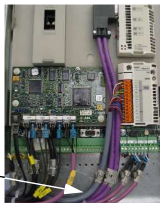
Conexión de la pantalla de un cable, con ayuda de abrazaderas metálicas, a la superficie metálica del portatarjetas en el convertidor DCS
