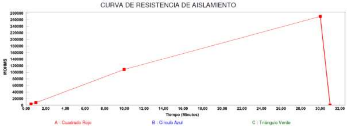
Figura 3 Tensión por Pasos hasta 10kV
