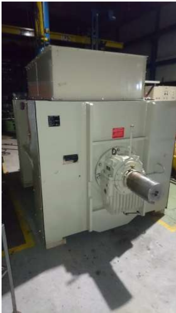
Imagen 1 Alternador terminado preparado para expedición
